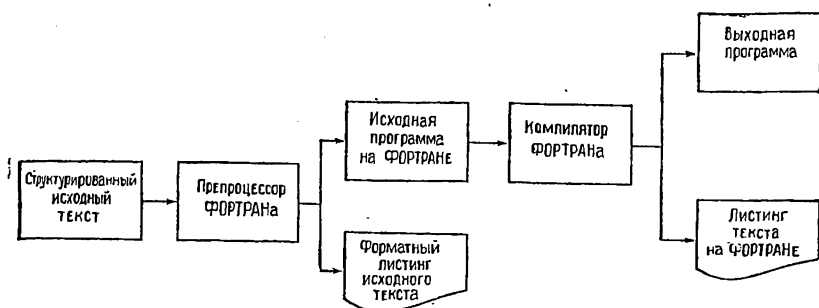
Рис. 7.3. Связь препроцессора и компилятора языка ФОРТРАН.
